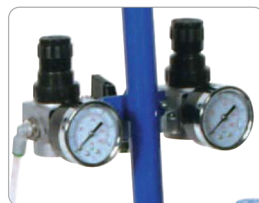
Le regolazioni pneumatiche ottimizzano la spruzzatura dei prodotti.
